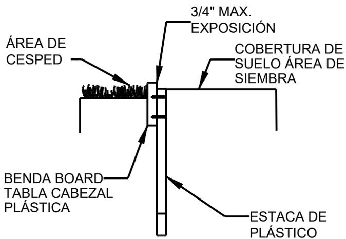
**2** UTILICE TORNILLOS PLATEADOS PARA INSTALAR ESTACAS A CADA 4 PIES. (MENOS ESTACAS PARA TRAMOS RECTOS Y MÁS PARA LAS CURVAS).
